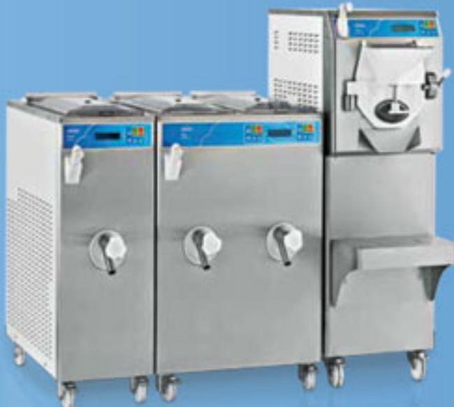
Řada strojů XPL na výrobu řemeslné zmrzliny je kompletní, skládá se z elektronických výrobníků LABO XPL, z elektronických pasterizátorů PASTO XPL a konzervačních a zracích kotlů AGE XPL. Všechny stroje Carpigiani jsou projektovány a realizovány tak, aby byly respektovány mezinárodní bezpečnostní a hygienické normy HACCP.
